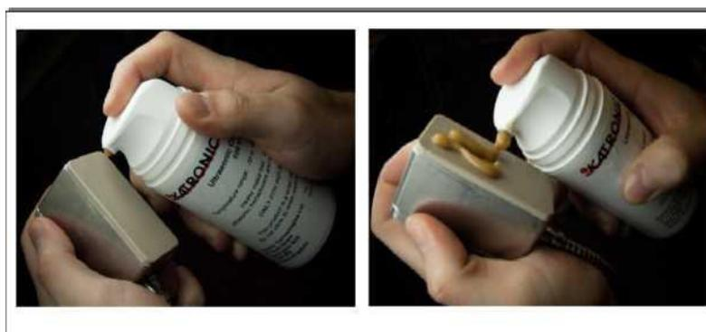
Рисунок 8: Нанесение акустического геля
