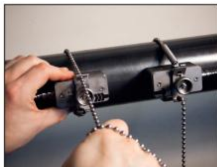
Датчик, установленный при помощи клипс и цепей
